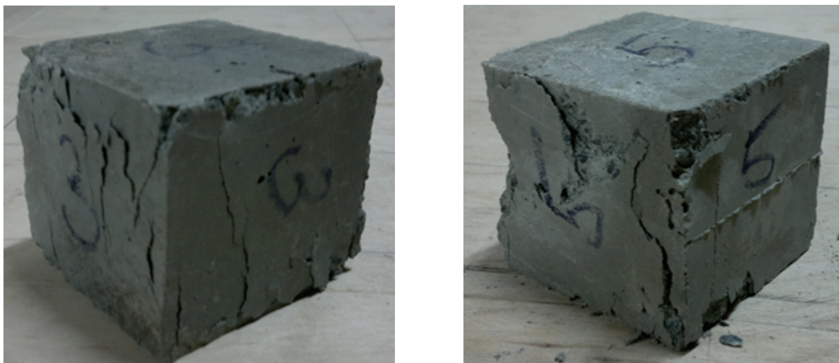
Рисунок 4.4 – Образцы серобетона после испытания на сжатие (сохранение формы)
