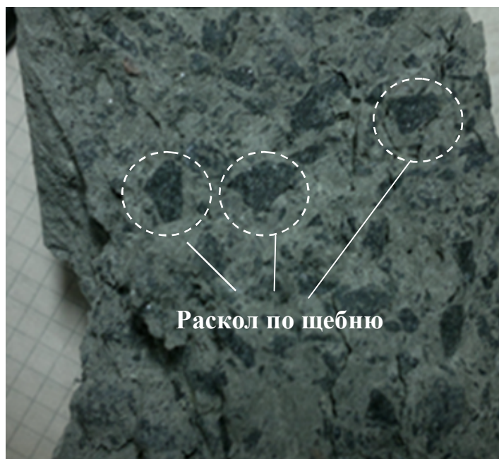
Рисунок 4.5 – Поверхность скола образца после испытания
